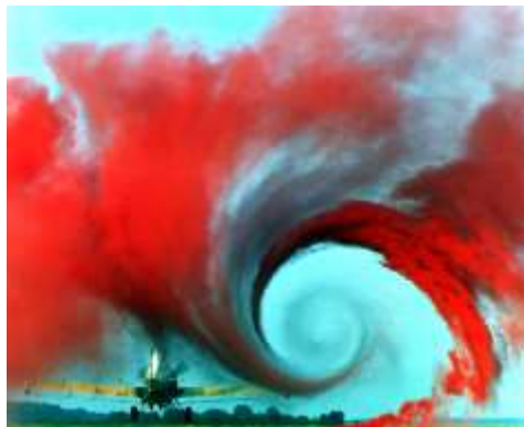
Turbulentinis sūkurys, susidaręs ant besileidžiančio lėktuvo sparno
