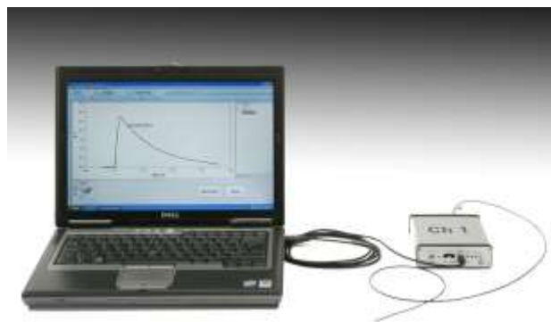
CMR-B-skaliarinis magnetinio lauko matuoklis ir išmatuoto signalo vizualizacija kompiuterio ekrane
