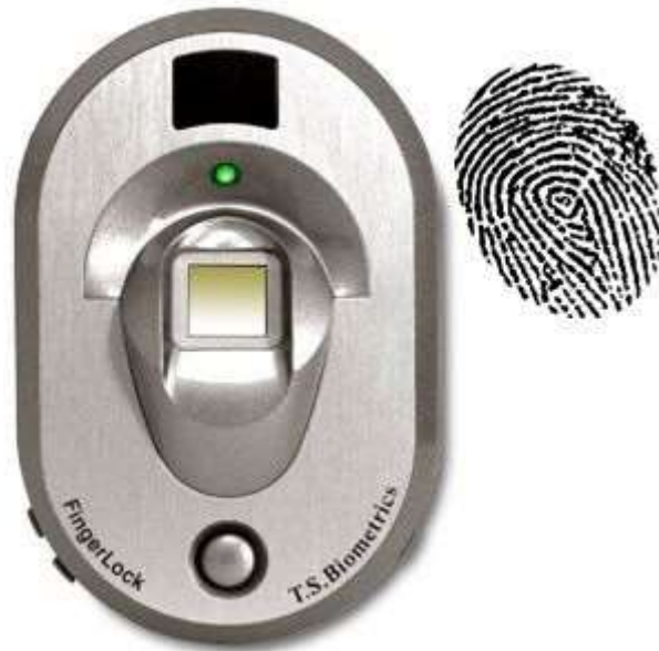
3 pav. Pirštų atspaudų jutiklis montuojamas kompiuteriuose ir kituose įrenginiuose (Peter Raymond nuotrauka [6]).
