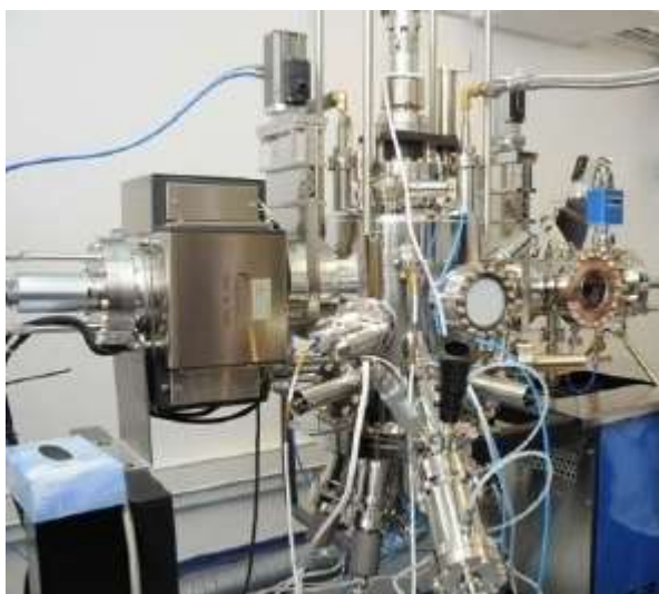
Molekulių pluoštų epitaksijos įrenginys FTMC. P. Malūko nuotrauka
