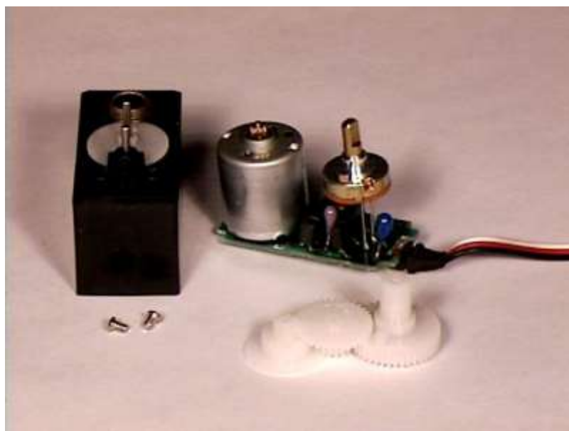
2 pav. Išardytas valdomasis mechanizmas (Seattle Robotics Society nuotrauka)
