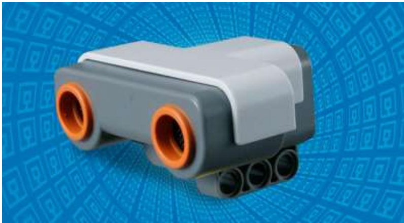
4 pav. LEGO Mindstorms NXT roboto ultragarsinis atstumo jutiklis (©2011 The LEGO Group, publikuojama gavus leidimą)
